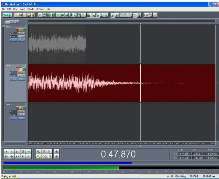
Рис. 10. Окно программы Cool Edit Pro при определении уровня сигнала на 30 дБ меньше чем в установленном режиме
