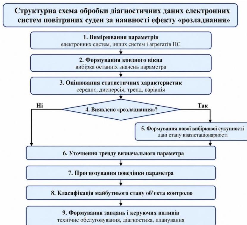
Рис. 2. Структурна схема обробки діагностичних даних електронних систем повітряних суден за наявності ефекту “розладнання”
