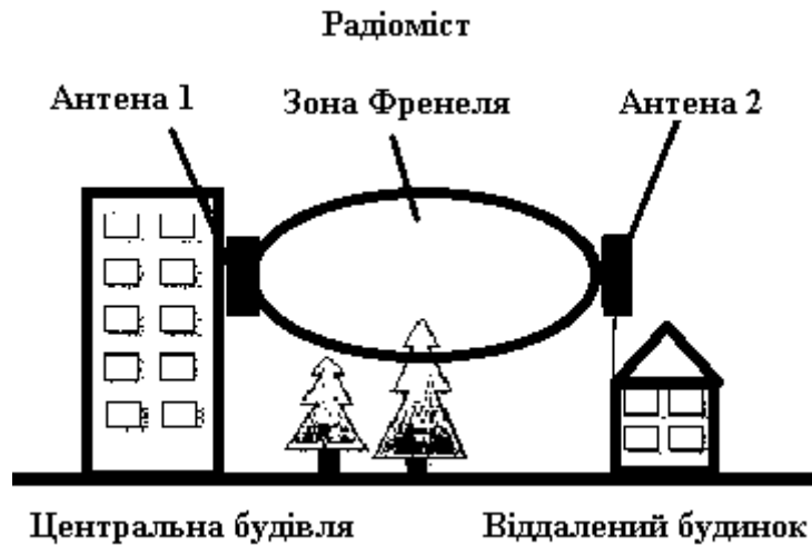
Рис. 1. Радіоміст, схема що пояснює що таке Зона Френеля
