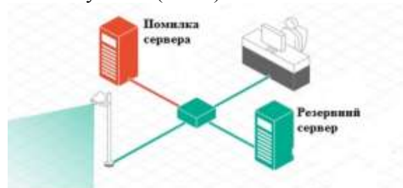
Рис. 3 - Резервування каналу з відображенням
