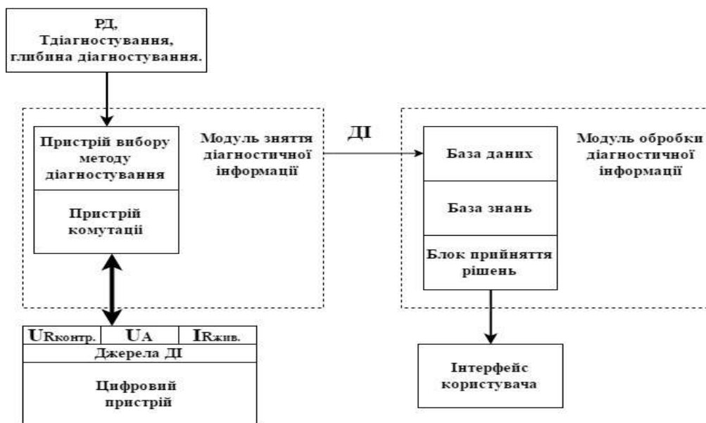
Рис. 2. Фрагмент нової автоматизованої системи технічного діагностування РЕТ
