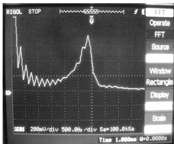
Рис. 10. Спектральна характеристика неавтономного генератора, реалізованого за схемою Чуа
