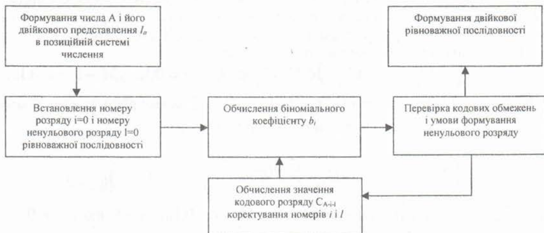
Рис. 1. Схема формування кодкових слів двійкового рівновагового коду
