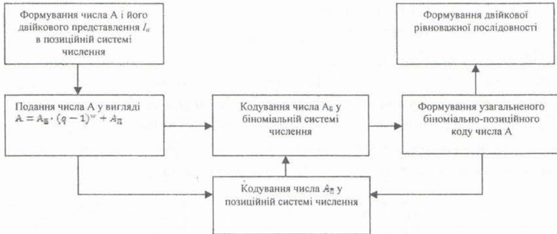
Рис.2. Схема формування кодових слів недвійкового рівно вагового коду
