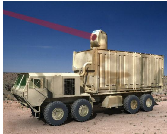
Рис.1. Лазерні системи ППО: стаціонарна, із бойовим киснево-йодистим лазером потужністю кілька мегаватів (а); мобільна, на автомобільній базі (б)
