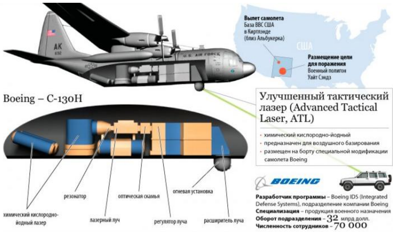
Рис.4. Схема розміщення вузлів бойового хімічного лазера на літаку [6]
