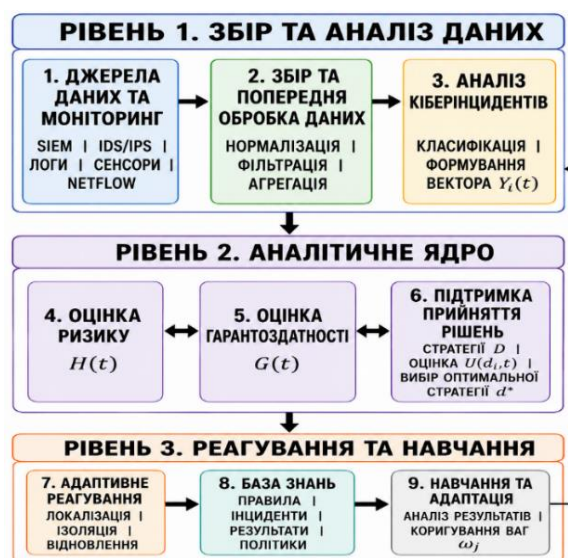
Рис. 2. Архітектура інтелектуальної системи підтримки прийняття рішень для адаптивного реагування на кіберінциденти
