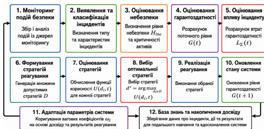
Рис. 1. Структурна схема методу адаптивного реагування на кіберінциденти для забезпечення гарантоздатності інформаційних систем ситуаційних центрів
