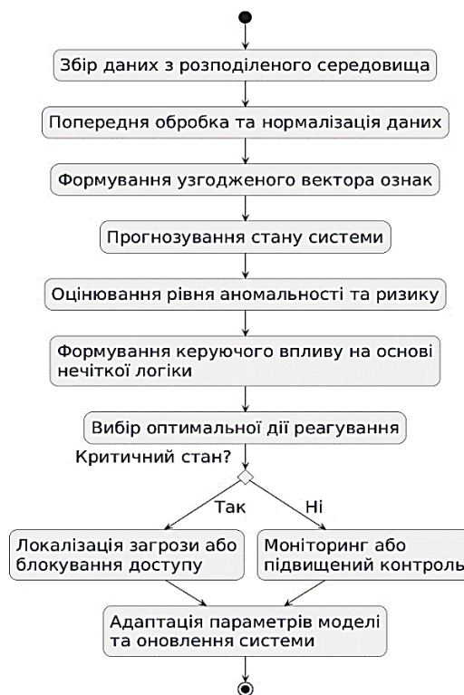
Рис. 4. Схема функціонування моделі адаптивного виявлення аномалій і вибору керуючого впливу
