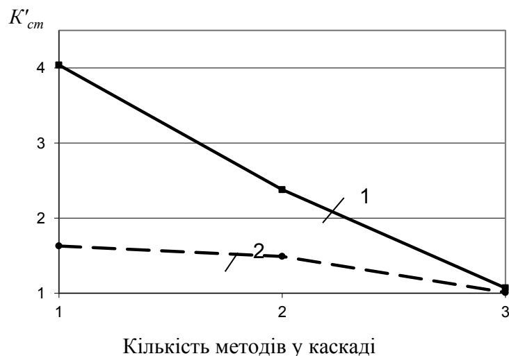
Рис. 1 Залежність ефективності стиснення інформації від кількості методів у каскаді: 1 – каскад Віттер-LZH-LZW для текстової інформації, 2 – каскад Віттер-матричний-LZW для вимірювальної інформації
