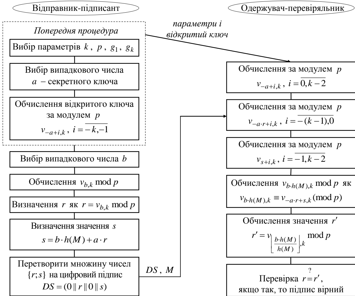
Рис. 1. Схема формування та перевіряння цифрового підпису на основі елементів V_k -послідовності.
