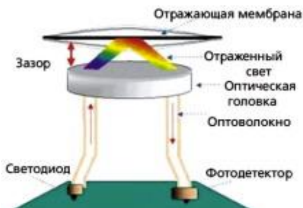
Рис. 3. Принцип работы оптического микрофона
