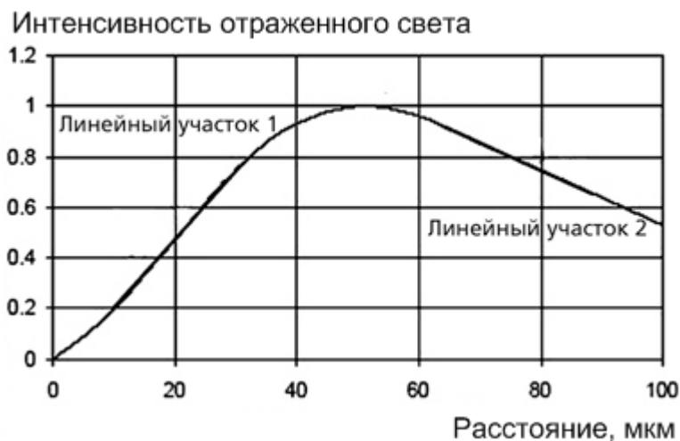
Рис. 5. Зависимость интенсивности света от расстояния между мембраной и оптоволокну
