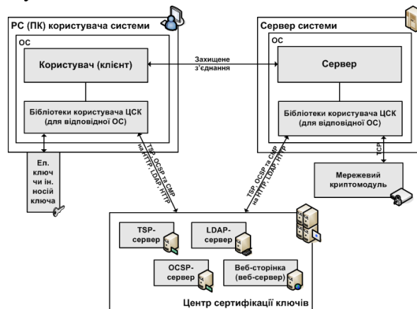
Рис. 3. Функціональна схема комплексу у складі системи
